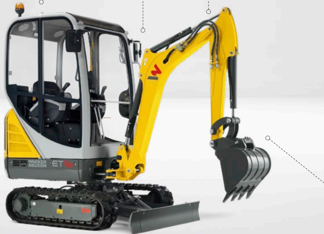
**Sehr guter Servicezugang** durch große Heckmotorhaube und demontierbare Bodenplatte in der Kabine
